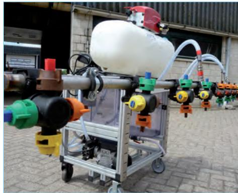
Alle Funktionen einer Spritze können dank dieser Vorführspritze klar demonstriert werden. Die Spritze ist leicht(35 kg), einfach gebaut und kann sehr einfach transportiert werden. Abmessung: 100 x 80 x 60 cm.
