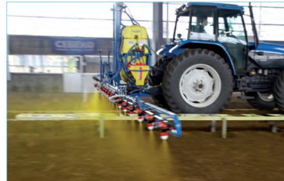
Las cubiertas de las bandejas son controladas pneumáticamente
